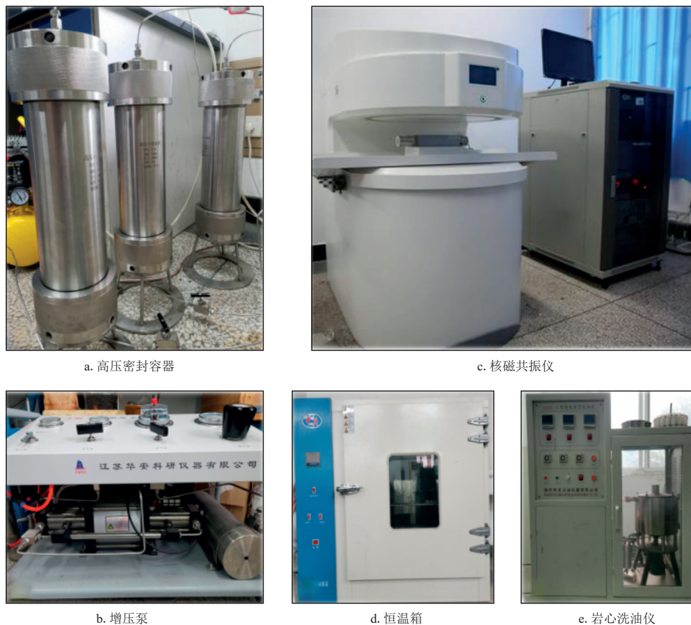
图2 渗吸实验使用仪器设备 Fig. 2 Instruments in imbibition experiments
